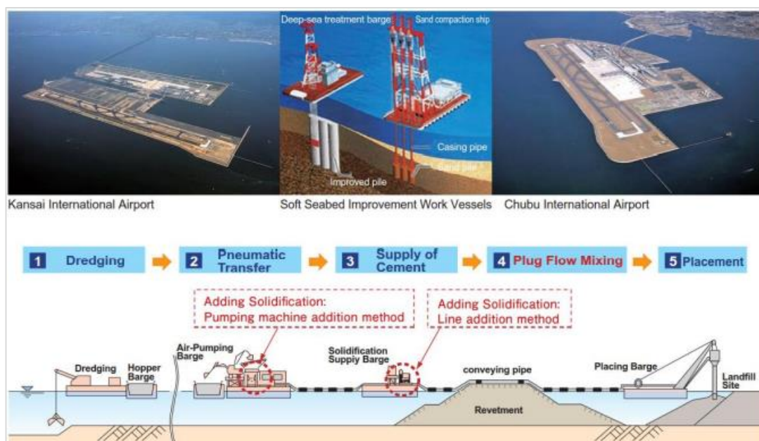
Рисунок 3-27 Примеры искусственного острова в Японии (верхний рисунок), построенного при помощи метода PFTM (нижний рисунок показывает рабочий процесс и свойства системы переработки вычерпанных наносов) (Гири и др., 2019, источник в интернете)
