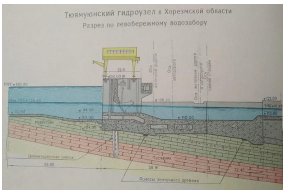
Рисунок 2-8 Разрез по левобережному каналу
