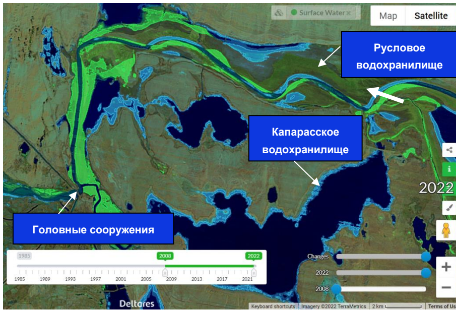
Рисунок 2-19 Зоны заиления (обозначено зеленым цветом), сформировавшиеся в 2008-2022 годах вдоль Руслового водохранилища возле головных сооружений (количественная оценка Aqua Monitor на основе спутниковых изображений)
