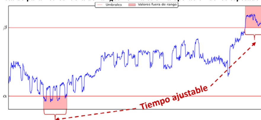
Diagrama 5 Vista de parámetros fuera de rangos normales en la operación de los espesadores
